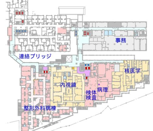
3階に核医学、検査、内視鏡、整形外科病棟を配置します。救急と繋がるエレベーターから内視鏡部門に直行し、緊急対応をスムーズにします。既存中・西病棟から連絡ブリッジを設けます。
