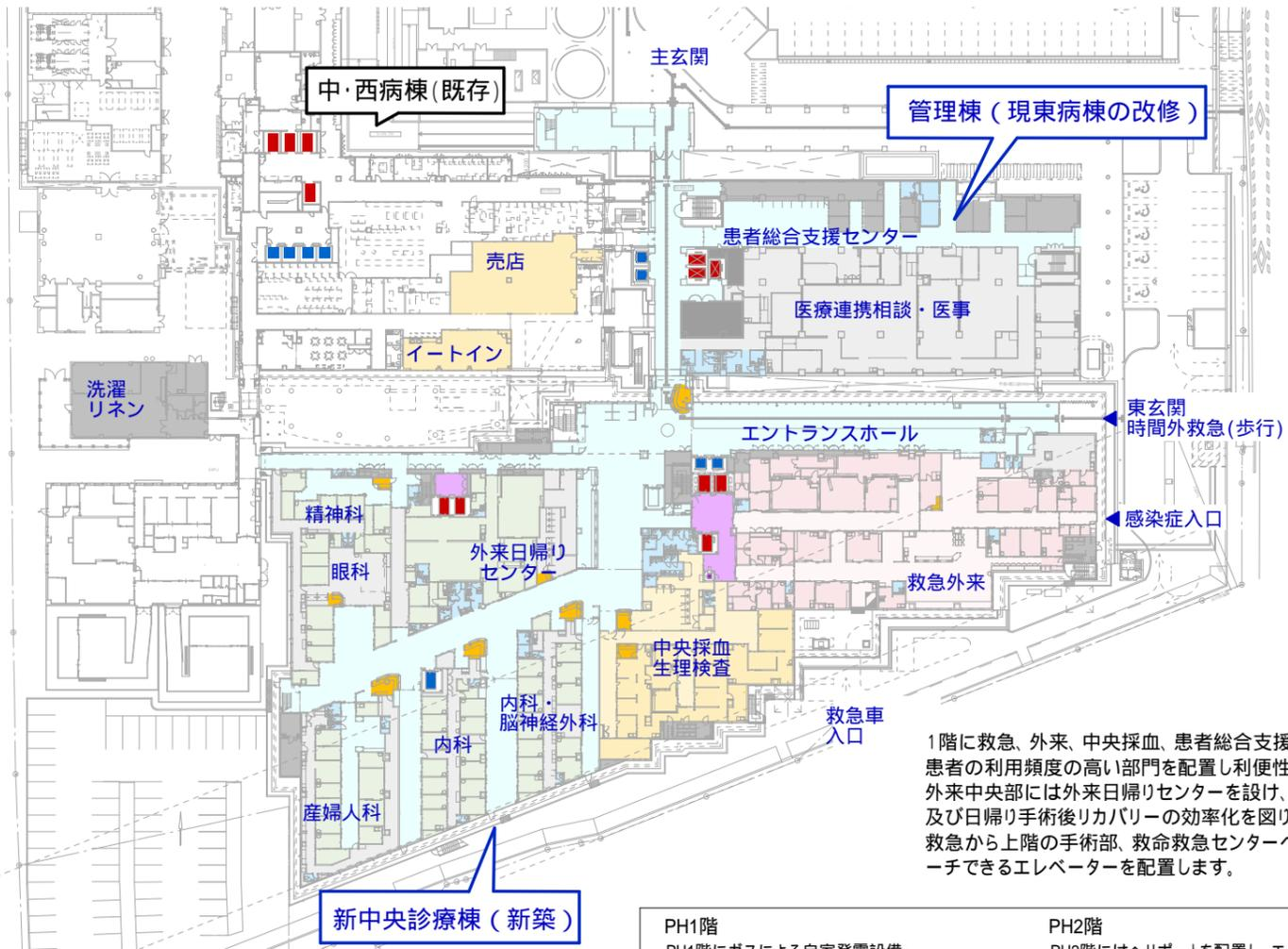
1階に救急、外来、中央採血、患者総合支援センターなど患者の利用頻度の高い部門を配置し利便性に配慮します。外来中央部には外来日帰りセンターを設け、処置・注射及び日帰り手術後リカバリーの効率化を図ります。救急から上階の手術部、救命救急センターへ直接アプローチできるエレベーターを配置します。
