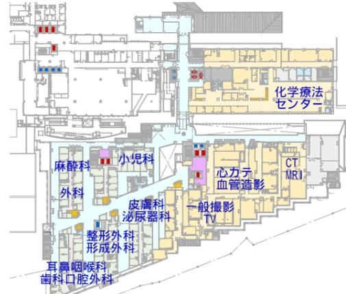
2階に外来、放射線部門を配置します。放射線部門は水害対策として上階へ配置し、また東側に将来拡張スペースを確保します。管理棟 (現東病棟) には、化学療法センターを患者が利用しやすい位置に配置します。外来はブロック受付とし、各診療科の位置がよくわかるよう配置します。
